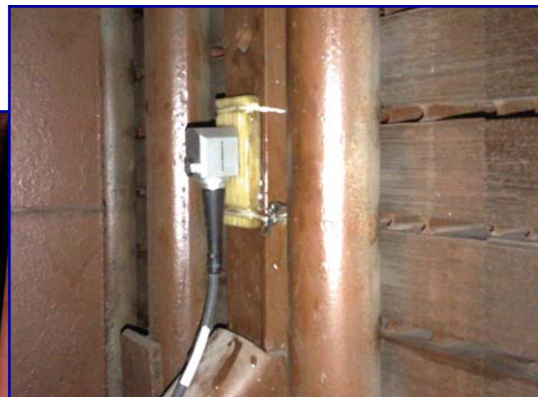
Установка датчиков вибрации корпуса статора и активного железа статора
