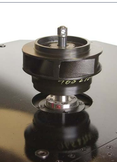
Быстрая смена деталей путем простого насаживания на шпиндель. Автоматический зажим и разжим детали.
