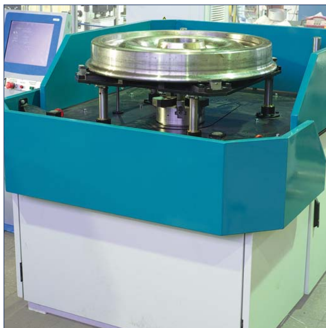
Балансировка железнодорожных колес. Укладка колеса на станок с использованием автоматического укладчика
