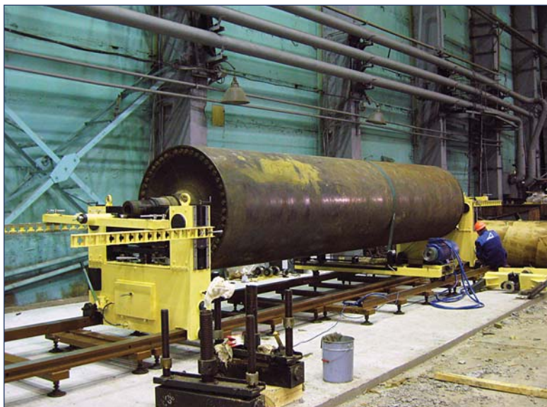
Балансировочный станок VM-20000 для уравнивания валков бумагоделательных машин и прокатных станов.
