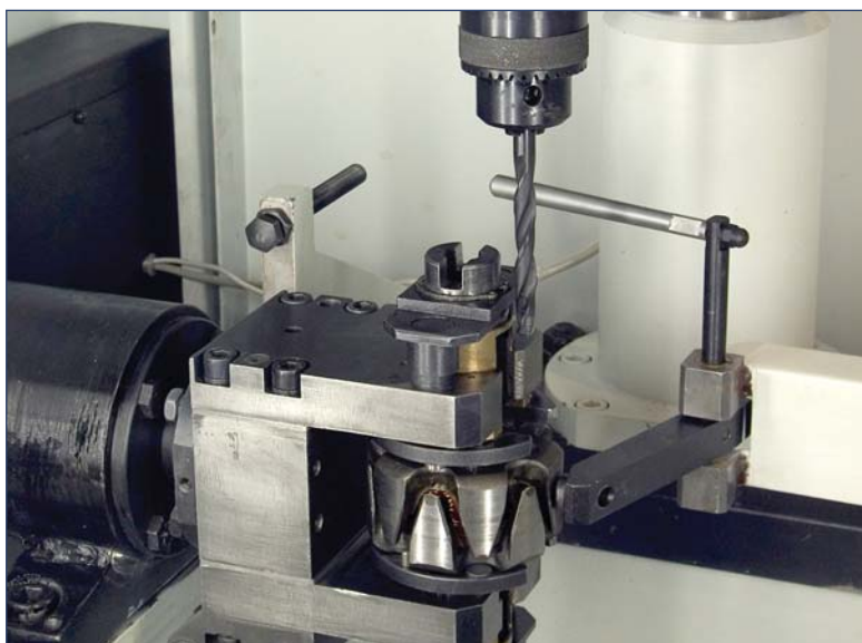
Автоматическая корректировка в двух плоскостях коррекции с переворотом изделия на 180°. Точность перемещения сверла – 0,02 мм.
