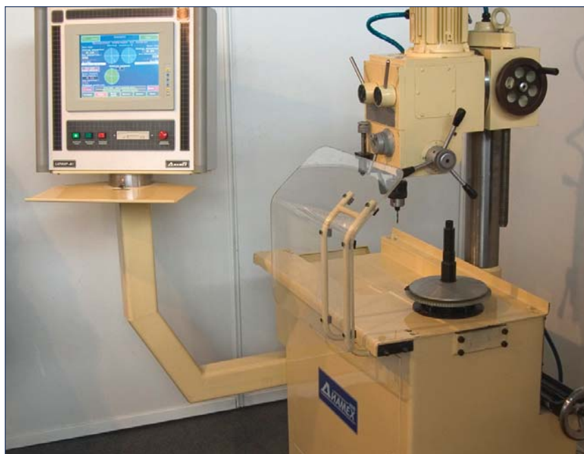
Возможность совмещения измерительной позиции и позиции коррекции. Коррекция возможна, как в одной плоскости, так и в двух. Деталь во время устранения дисбаланса надежно фиксируется на шпинделе станка.
